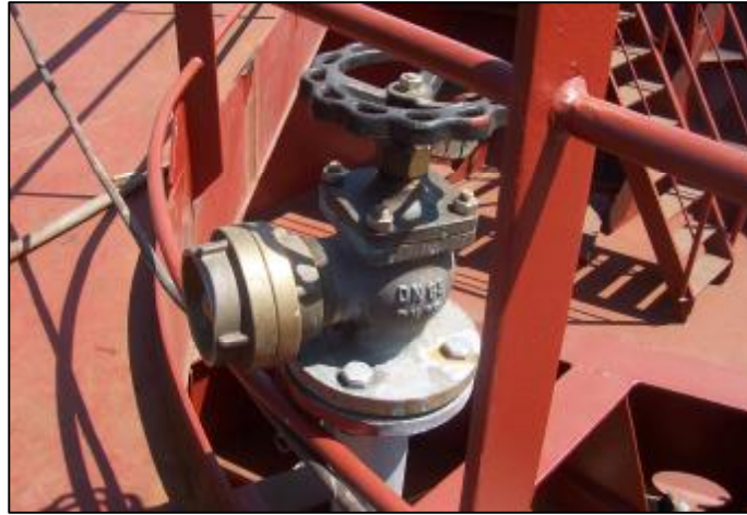
Resim 2.5: Güverte yangın bağlantısı
