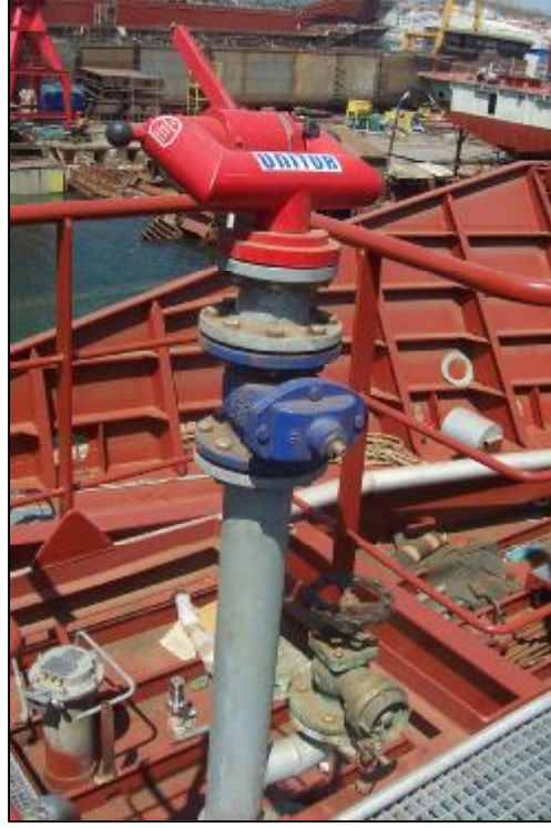
Resim 2.4: Güverte yangın bağlantısı
